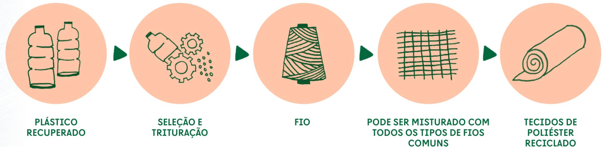
Como as garrafas de plástico são feitas do mesmo polímero que o poliéster, é possível destruí-las e refazê-las, obtendo poliéster "reciclado". O processo de fabrico do fio é simples: os plásticos usados são cortados, triturados,
